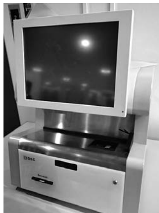
自動貸し出し装置
